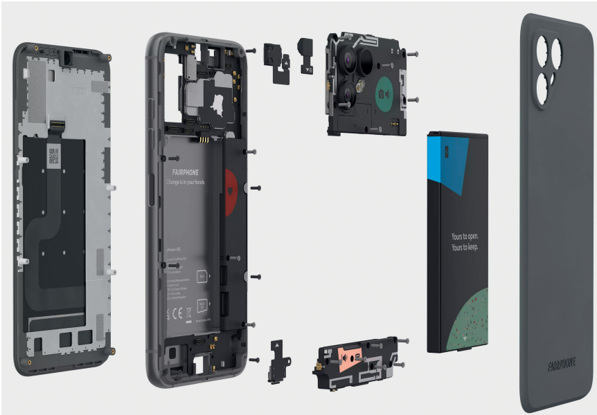
Bild 3. Das modulare Design erleichtert die Reparatur und das Recycling des Smartphones „Fairphone“. © Fairphone
